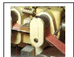
Mit hoher Geschwindigkeit versehen moderne Wickelmaschinen die einzelnen Bonbons mit einer Umhüllung in unterschiedlicher Grösse und Form.
